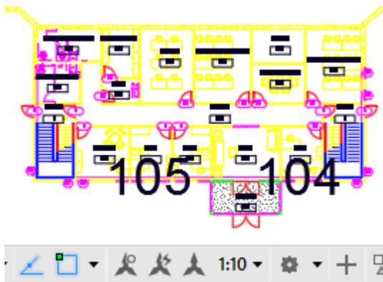
3. Cuando a la vista se le cambia la escala a una que no tiene configurada uno de los textos, por ejemplo 1:5, el texto que no tiene está escala configurada no se visualiza (texto 104).
