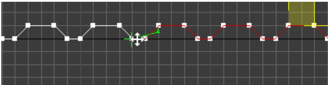
3. Fusionar con herramienta weld todas las líneas que correspondan al losacero, seleccione el modo vertex para fusionar los vértices para que en conjunto formen una sola spline. Seleccionar la spline y buscar la herramienta **Outline** ingrese un valor aproximado de grosor requerido.
