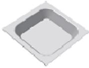
La herramienta de punzonado debe tener un boceto con una sola marca de centro definida. La cara de chapa debe tener un boceto con una o varias marcas de centro consumidas.
